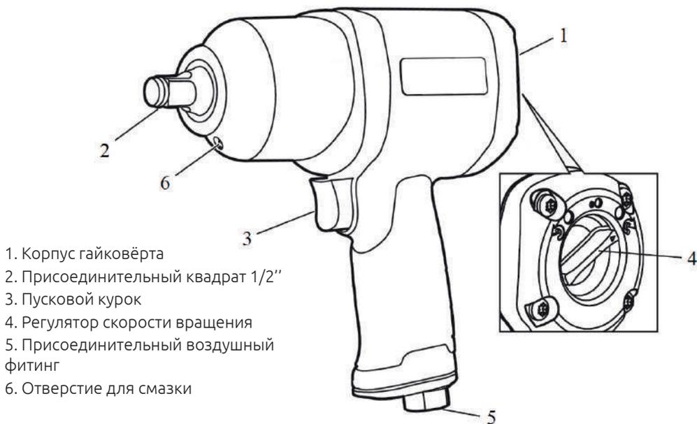
Рис. 1. Основные элементы пневматического гайковёрта «БЛАЗАР»
